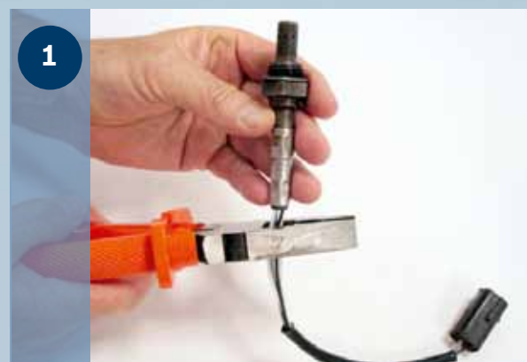
1 Oddel'te kábel od demontovanej sondy.
