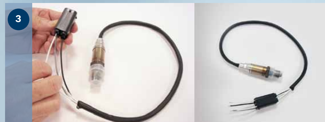
3 Vložte vodiče do konektora dodávaného s novou univerzálnou sondou.
